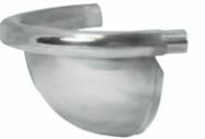
Устанавливаются на торцах водосточного желоба. Заглушки желоба универсальные – устанавливаются как с правой, так и с левой стороны желоба. Хорошо сочетаются с отводом трубы декорированным. При их установке необходимо использовать вытяжные заклепки и клей (ТЕС-7).
