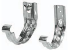
Предназначен для крепления водосточного желоба по аналогии со стандартными крюками крепления желоба, и может быть использован как в качестве короткого крюка, так и в качестве длинного (при условии применения удлинителя крюка). Наличие изгиба для завитка желоба в передней части позволяет устанавливать желоба в крюки без отгиба установленного ранее фартука («капельника»). Наличие дополнительных ребер жесткости делает крюк очень прочным.
